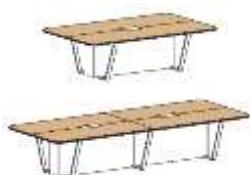
Опоры столов комбинированные: опорные короба из ДСП и металлические опоры. Металлическая опора имеет изгибы с внешним радиусом 20 мм и угловым сварным соединением с внутренней стороны. Опоры с регулировкой по высоте: 0-12 мм.
